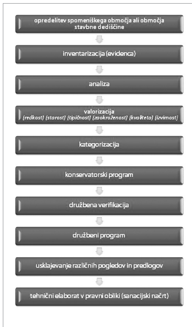
Slika 3: Metoda izdelave konservatorskega programa in pobud za funkcionalni program – osnova za izdelavo sanacijskega načrta (prenove) (Šumi, 1978, str. 29–40)
